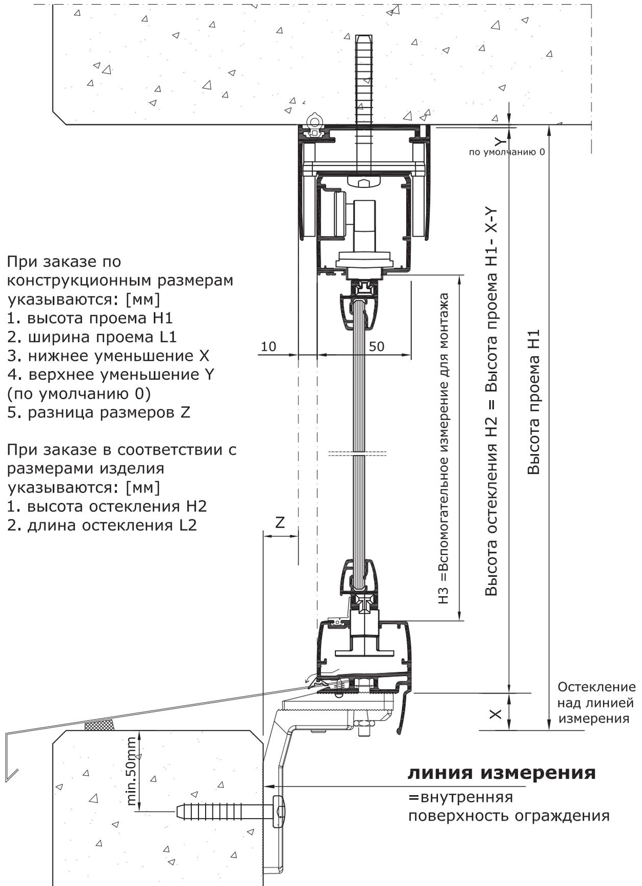
При заказе по конструкционным размерам указываются: [мм]
