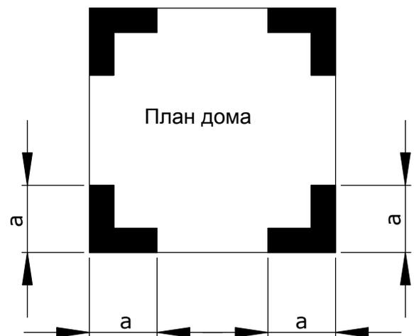
Все расчеты должны быть согласованы с местными строительными нормами. На схеме показатель  $a$  (м) составляет 10% от наибольшего значения по горизонтали ( $b1$  или  $b2$ ) или  $0,4 h$ . Выбирается наименьшее значение. Влияние на таблицу, приведенную на следующей странице:
