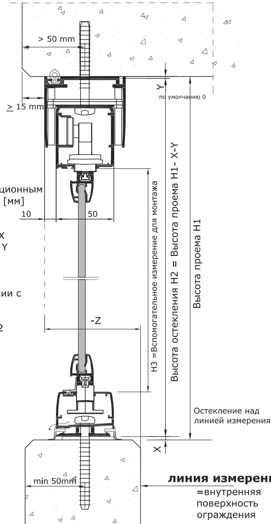
При заказе по конструкционным размерам указываются: [мм]
